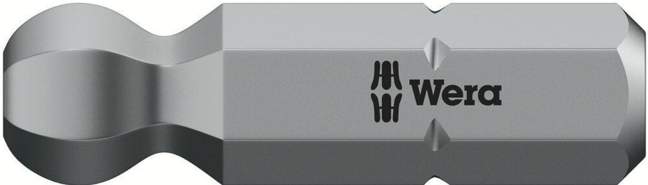
Robuste punte Wera per viti ad esagono cavo, per uso universale. I profili di trascinamento sferici consentono di deviare o orientare l'asse dell'utensile rispetto all'asse della vite, in modo da poter avvitare le viti "intorno agli angoli". Esagono da 1/4", adatto ai supporti DIN ISO 1173-D 6.3.
