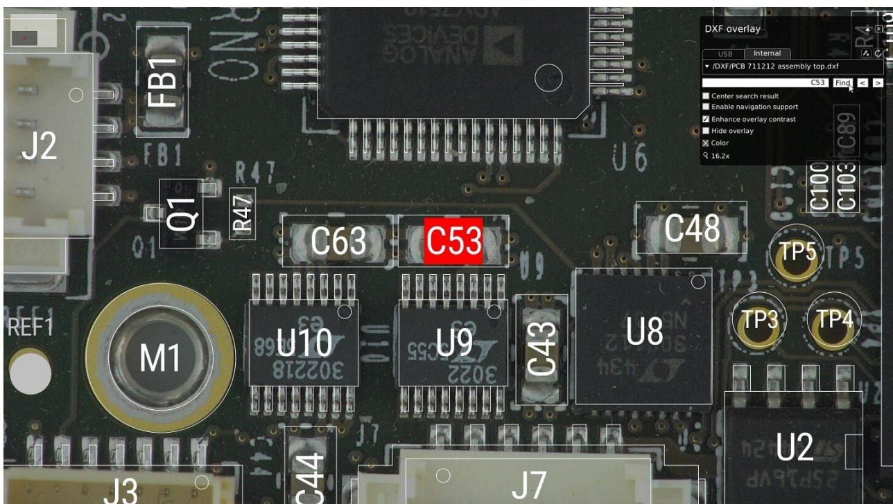
Con la crescente miniaturizzazione dei componenti, può essere difficile trovare il componente che si sta cercando su un PCB. Tuttavia, se si inserisce il nome del componente nella barra di ricerca, l'applicazione di sovrapposizione DXF lo evidenzia, rendendo incredibilmente facile trovare il componente necessario nelle stazioni di rilavorazione.
