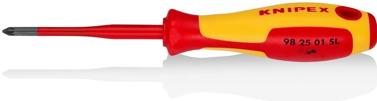
Cacciavite (Slim) per viti con testa a croce: diametro di isolamento della lama ridotto per elementi a molla e a vite bassi..: Impugnatura ergonomicamente ottimizzata a 2 componenti per una trasmissione della potenza a basso affaticamento e facile da usare. Forma della maniglia antirollio. - Misura: PZ1 - Lunghezza lama: 80 mm - Lunghezza impugnatura: 107 mm - Lunghezza lama non isolata: 15 mm - Testato VDE: Sì
