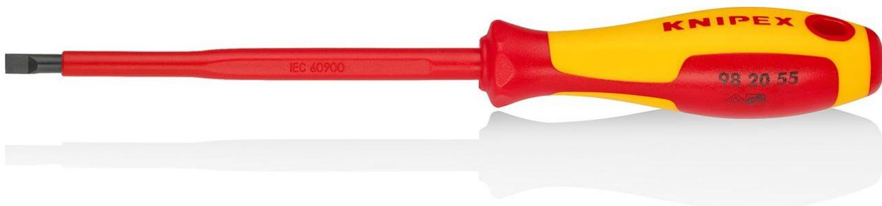
Cacciavite per viti con intaglio: impugnatura ergonomicamente ottimizzata a 2 componenti per una trasmissione della forza a basso affaticamento e facile da usare. Forma della maniglia antirollio. - Lunghezza lama: 125 mm - Lunghezza lama non isolata: 15 mm - Lunghezza impugnatura: 107 mm - Larghezza lama: 5,5 mm - Spessore lama: 1,0 mm - Testato VDE: Sì
