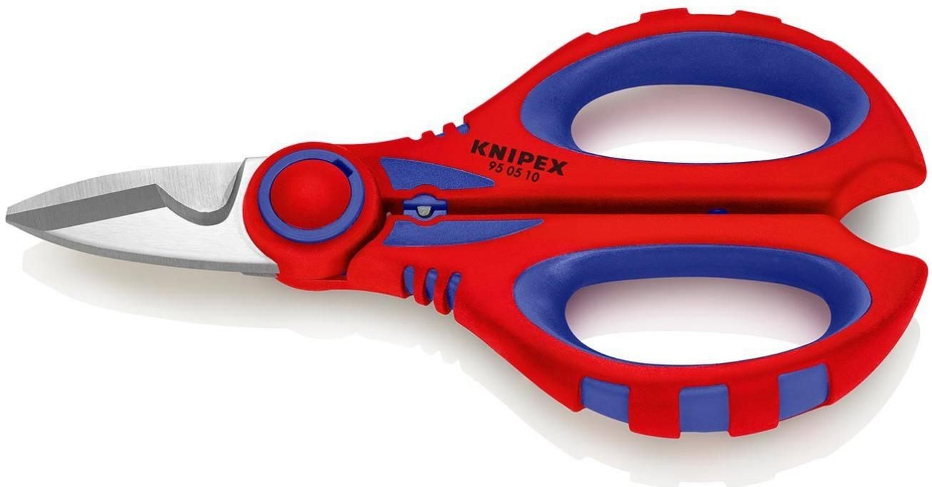
Con funzione di crimpatura per capicorda. Rettifica di precisione con microserratura per un taglio netto e antiscivolo. Funzione di crimpatura per crimpare capicorda fino a  $\varnothing$  6,0 mm. Manici con guaine multicomponente, rinforzate con fibra di vetro. Taglienti in acciaio inox, durezza dei taglienti 56 HRC. Con custodia in plastica per cintura. Con punto di crimpatura per capicorda fino a 6,0 mm<sup>2</sup>. - Capacità millimetrica: 6,0 mm<sup>2</sup>.
