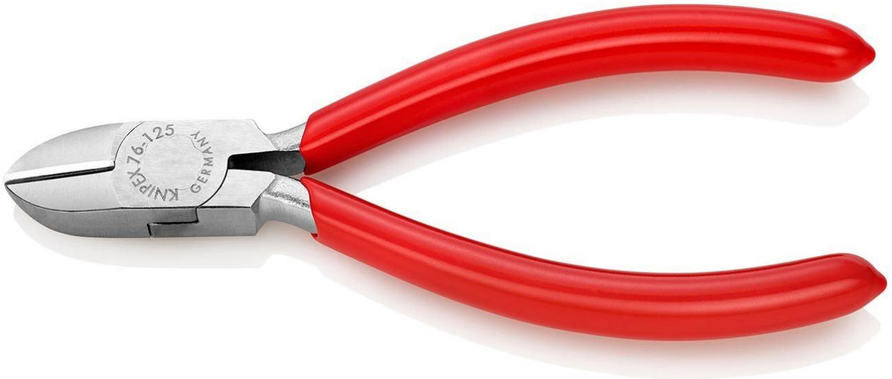
Con bordi di taglio affilati e a chiusura precisa. Taglienti ulteriormente temprati a induzione, durezza dei taglienti circa 63 HRC. Giunto intarsiato, con smusso. - Forma: 0 - Valori di taglio filo medio duro (diametro): Ø 2,3 mm - Valori di taglio filo duro (diametro): Ø 1,5 mm - Valori di taglio filo morbido (diametro): Ø 0,4 - 3 mm - lunghezza ganascia (B): 16 mm - spessore ganascia (all'articolazione) (D): 9 mm - larghezza testa (A): 14,5 mm
