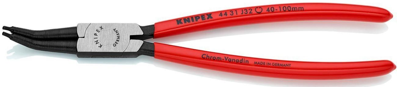
Forma robusta, forgiata. Puntali robusti e antiscivolo. Basato sulle norme DIN 5256 C e DIN 5256 D, ma con un angolo di 45°. - Forma: 3 - Capacità per diametri di foro: Ø 40 - 100 mm - Punta (diametro): Ø 2,3 mm
