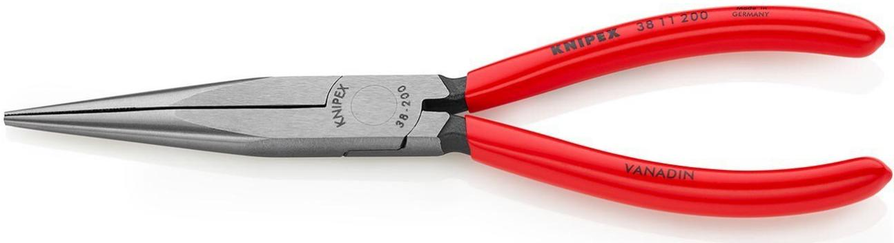
Elevata resistenza alla flessione delle punte delle pinze. Ganasce diritte e piatte. - Forma: 1 - spessore della mascella (all'articolazione) (T1): 9,5 - larghezza della punta (E): 3,0mm - spessore della punta (D1): 2,5mm - lunghezza della mascella (L3): 73,0mm - larghezza della testa (W3): 17,5mm
