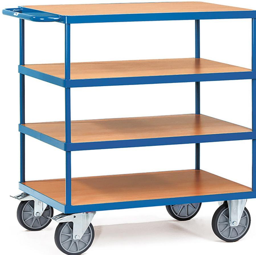
Tubolare d'acciaio e profilato d'acciaio saldato, verniciato a polvere RAL 5007. 4 piattaforme in tavole di legno derivato, superficie in faggio decorato. 2 ruote piroettanti e 2 ruote fisse, pneumatici in TPE, mozzi con cuscinetti a sfera a gola profonda. Dispositivo di bloccaggio sulle ruote piroettanti, in conformità alla norma europea EN 1757-3 (sicurezza dei carrelli a piattaforma).
