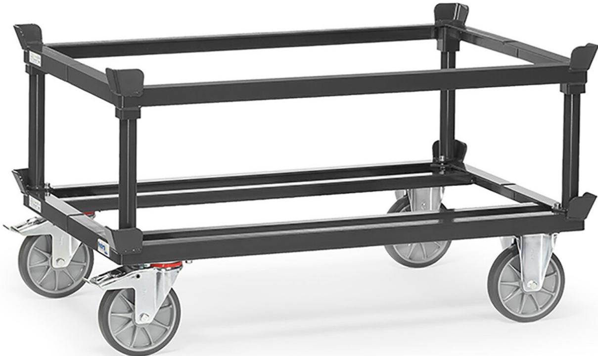
Per pallet piatti e pallet a rete. Robusta struttura angolare in acciaio saldato, con 4 angoli, verniciata a polvere, grigio antracite RAL 7016. 2 ruote piroettanti e 2 ruote fisse, pneumatici in TPE, mozzi con cuscinetti a sfera a gola profonda, freni sulle ruote piroettanti, in conformità alla norma europea EN 1757-3 (sicurezza dei carrelli elevatori a piattaforma). Ruote standard per carichi medi. Funzionamento a bassa rumorosità.
