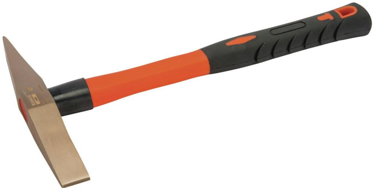
Gli utensili non scintillanti vengono utilizzati in aree in cui esiste un rischio potenziale di incendio ed esplosione a causa di scintille volanti. Martello per saldatura con testa in rame e berillio e manico in fibra di vetro, antiscintilla, 600 g.
