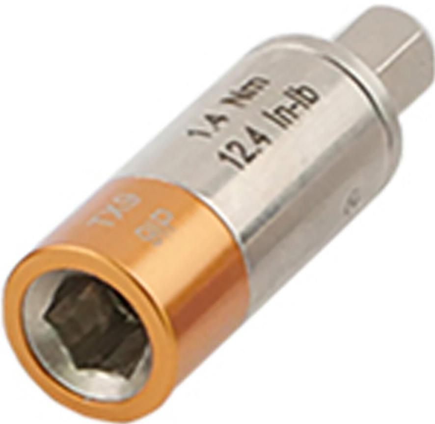
Il valore di coppia è preimpostato nell'adattatore e può essere bloccato tra un qualsiasi utensile di presa standard e un bit da 1/4 di pollice. Questo trasforma ogni porta-inserti in un cacciavite dinamometrico.
