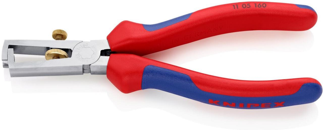
Per conduttori rigidi, a trefoli e a trefoli fini con isolamento in plastica o gomma con sezione massima di  $\varnothing$  5 mm o 10 mm<sup>2</sup>. Facile regolazione del diametro del filo o del trefolo desiderato mediante vite zigrinata e controdado. - Forma: 0 - Valori di spelatura millimetri quadrati: 10mm<sup>2</sup> - Valori di spelatura (diametro):  $\varnothing$  5,0 mm - AWG: 7
