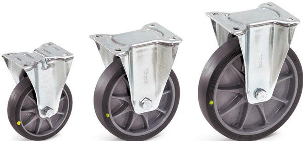
Alloggiamento in lamiera d'acciaio zincata. Ruote con pneumatici TPE-ESD (elastomero termoplastico a conduzione elettrica). Mozzi con cuscinetti a sfere a gola profonda di precisione. I pneumatici sono antitraccia (non-chalking).
