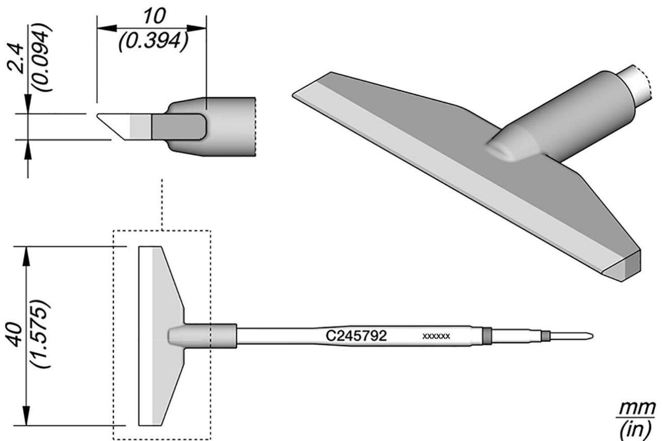
Punte di saldatura serie C245 per saldatori T245 (ex AD-2245). Sono adatti per saldature generiche. Modalità sleep e sleep nel vassoio.
