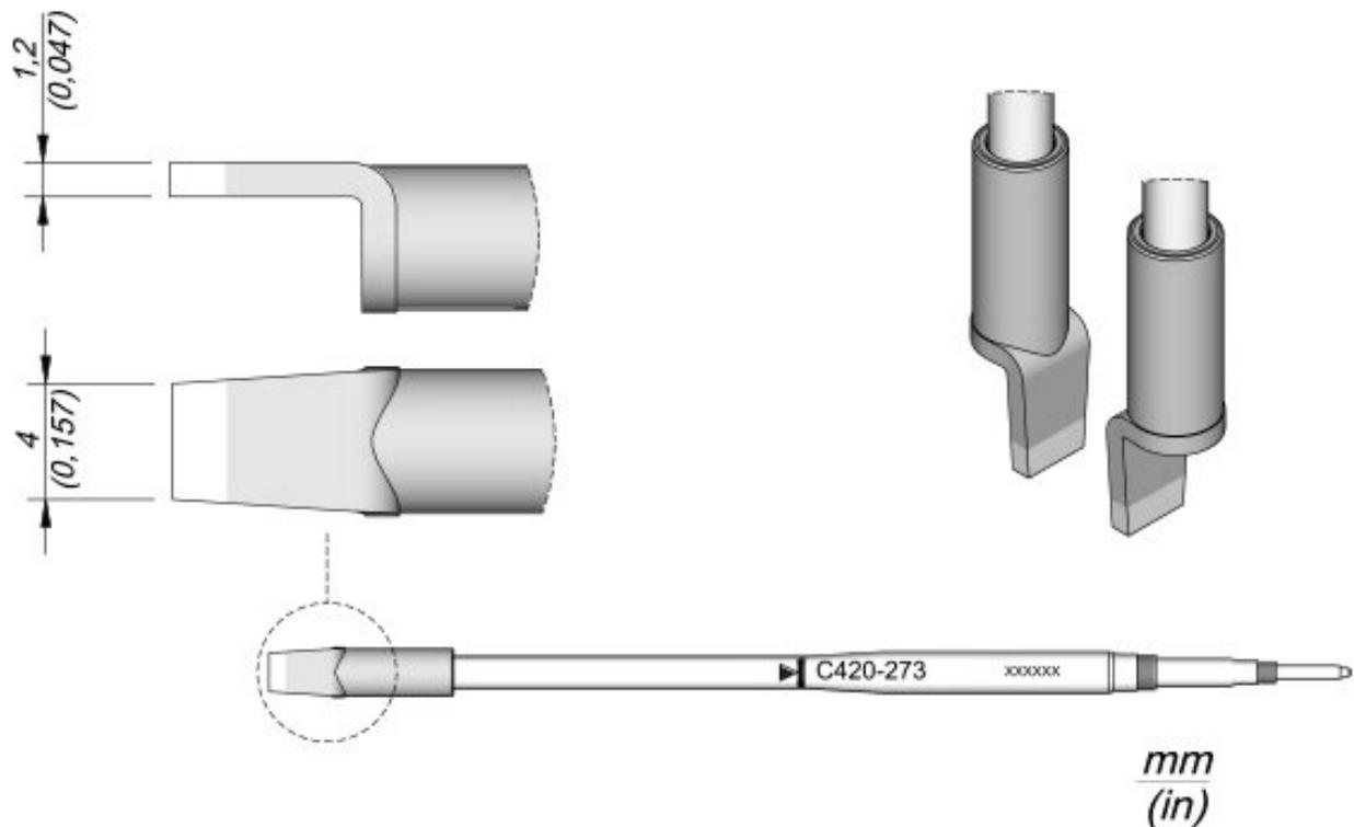
Le serie di punte C420 sono adatte per saldare e dissaldare componenti SMD. Le punte per saldatura sono compatibili con le pinzette termiche HT420 e sono vendute separatamente.
