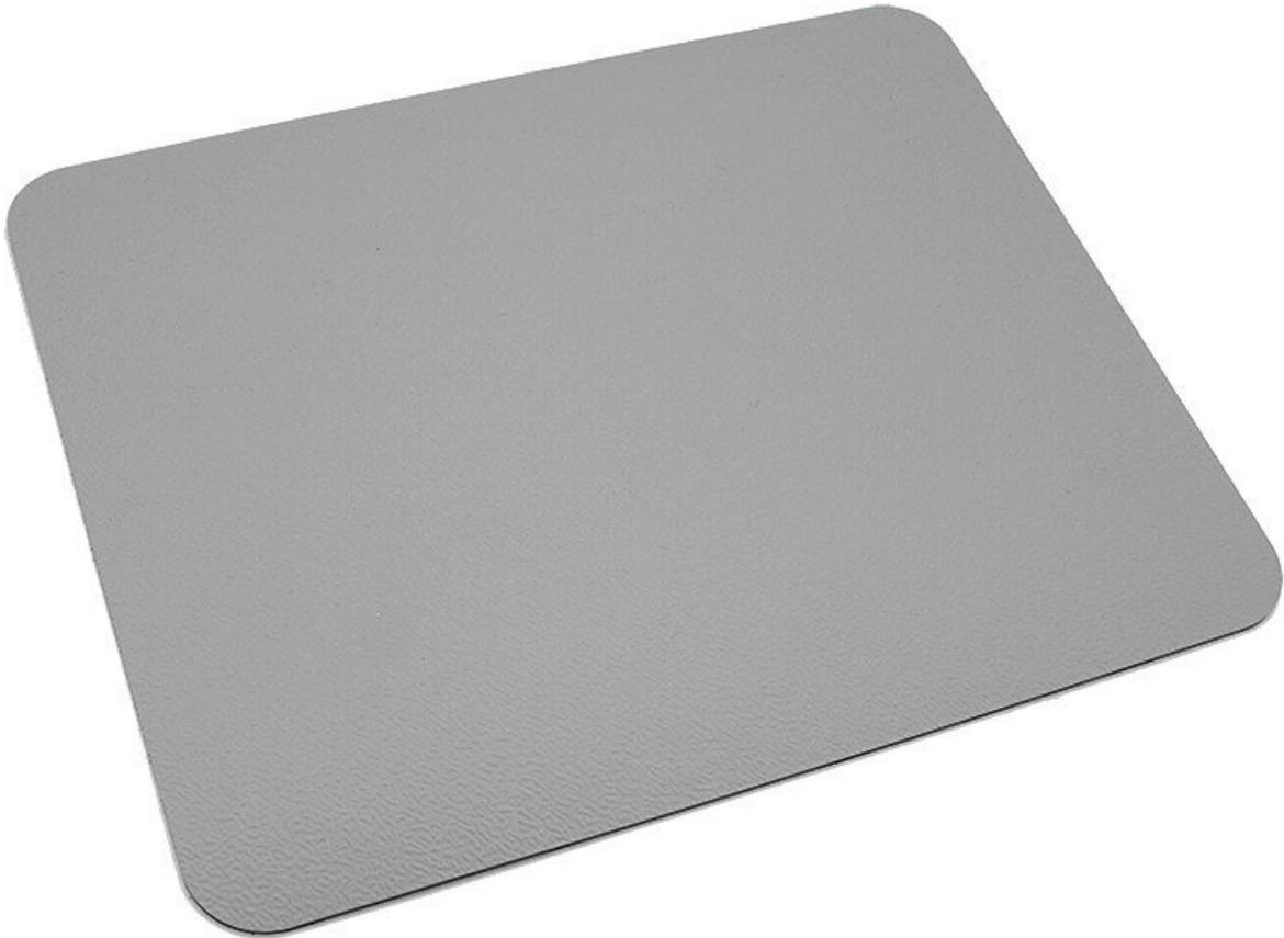
SafeGuard offre un tappetino da tavolo ESD di alta qualità in grigio chiaro. Questo tappetino di qualità superiore è resistente al calore e alle saldature, agli agenti chimici e agli oli, è permanentemente elastico, resistente all'abrasione e confortevole. Il tappetino a due strati (dissipativo/conduittivo) ha una resistenza superficiale compresa tra  $10^7$  e  $10^8$  ohm. Conforme alla direttiva RoHS e con superficie antiriflesso per facilitare il lavoro.
