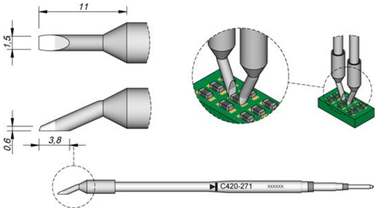
Le serie di punte C420 sono adatte per saldare e dissaldare componenti SMD. Le punte per saldatura sono compatibili con le pinzette termiche HT420 e sono vendute separatamente.
