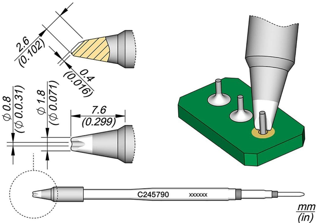
Punte di saldatura serie C245 per saldatori T245 (ex AD-2245). Sono adatti per saldature generiche. Modalità sleep e sleep nel vassoio.
