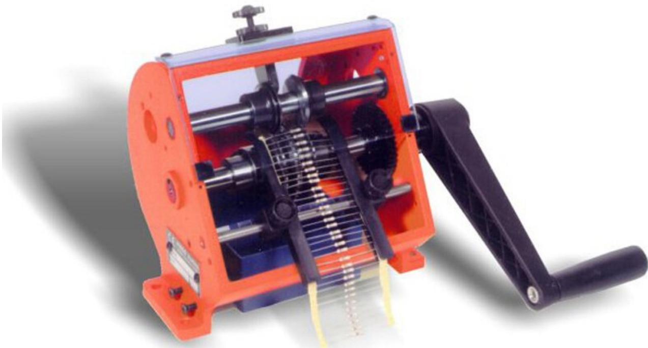
Macchina per il taglio e la piegatura di componenti nastrate e assiali per il montaggio a innesto
