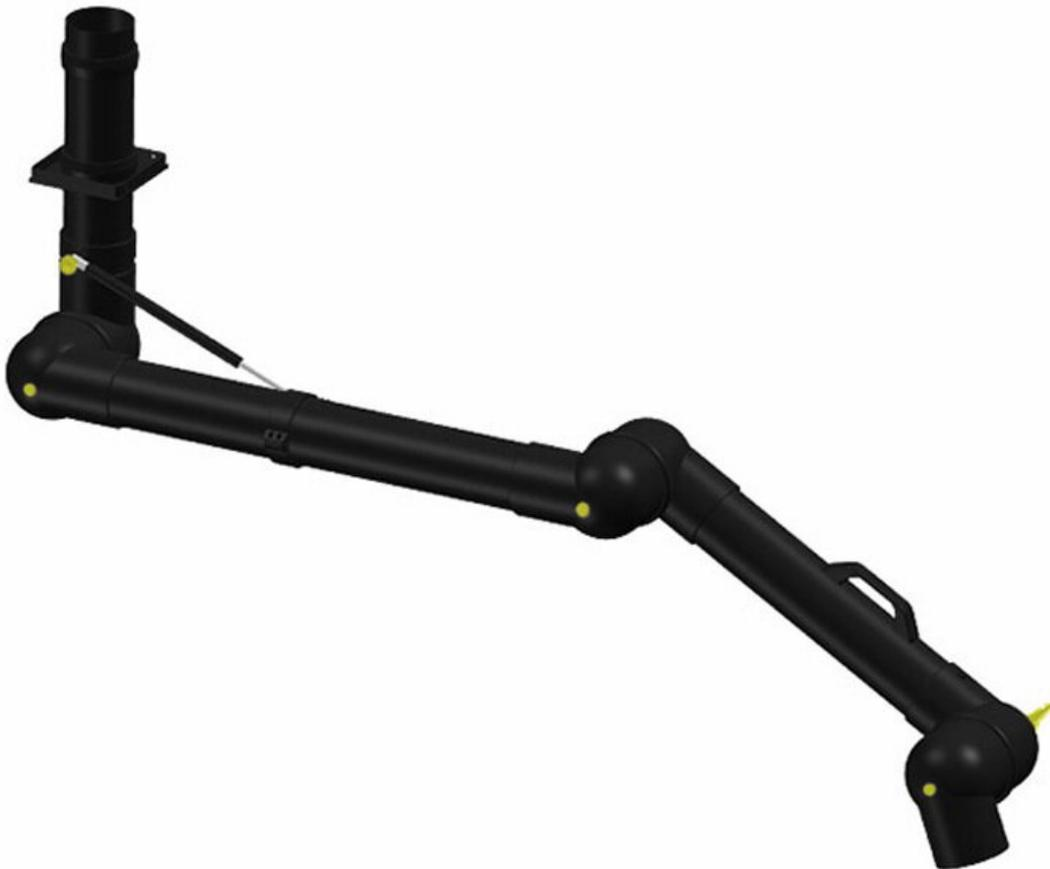
Il sistema di estrazione Alsident DN 100 è particolarmente adatto per grandi quantità di sostanze inquinanti o per compiti di raccolta più grandi. I tubi hanno un diametro di 100 mm e il volume d'aria consigliato per l'estrazione è compreso tra 140 m<sup>3</sup>/h e 400 m<sup>3</sup>/h. Il sistema ESD viene fornito con un filo di terra con una resistenza da 1MΩ.
