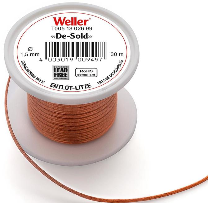
I fili di dissaldatura sono costituiti da trecce di rame impregnate di disossidante. Il flusso permette di bagnare il rame senza problemi. La forza capillare nella maglia fine assorbe la saldatura liquida.
