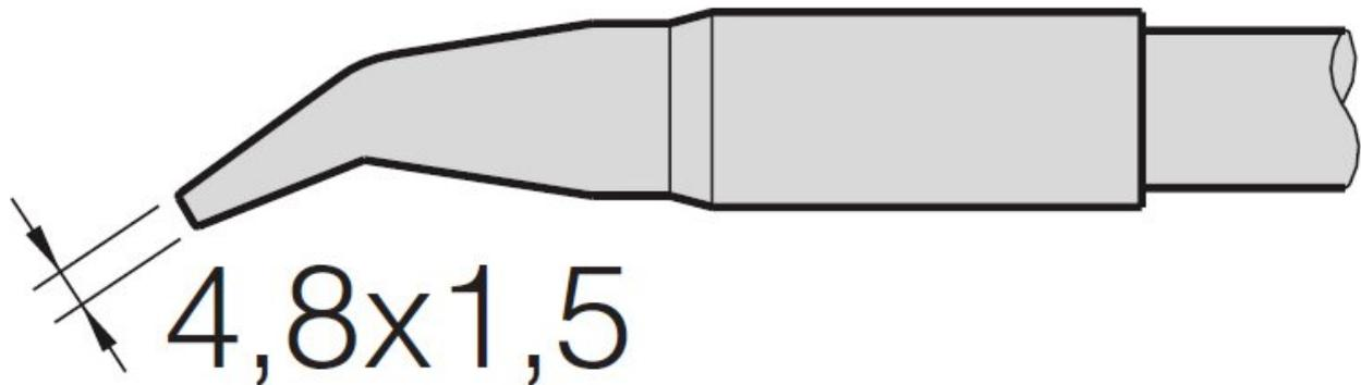
Le serie di punte per saldatura C130 sono adatte al manipolo AP130 e hanno punte curve che si adattano perfettamente alla posizione del filo di stagno. Le punte possono essere allineate sul manipolo tramite il dispositivo antitorzione.
