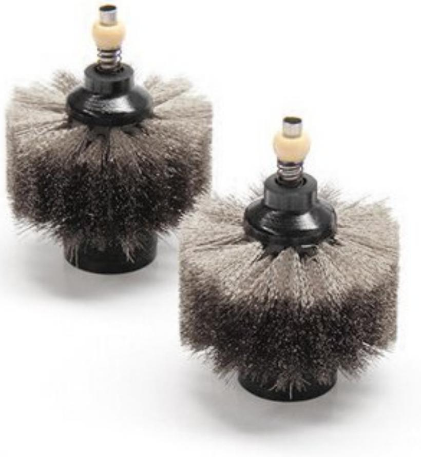
Le spazzole di pulizia JBC in alpacca sono state progettate appositamente per il dispositivo di pulizia CLMB-A. Con un diametro di 50 mm, offrono una soluzione di pulizia efficace per le vostre applicazioni. Le spazzole si attivano non appena l'utente inserisce la punta nella finestra del dispositivo di pulizia, consentendo una pulizia rapida e precisa. Il tempo di applicazione è di circa 1 secondo per il CLMB-A.
