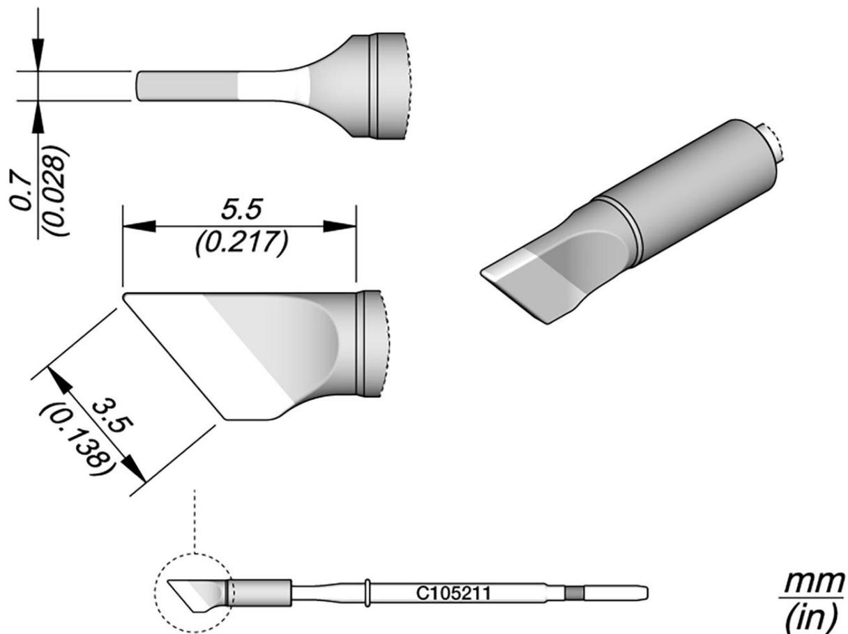
Le punte per saldatura della serie C105 sono le punte più piccole della serie JBC e sono ideali per saldare e riparare componenti molto piccoli. Sono compatibili con i manipoli nano NT105 e NP105
