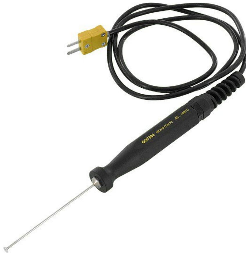
Sonda NiCr-Ni/Tipo K per WTM-100D / 200D
