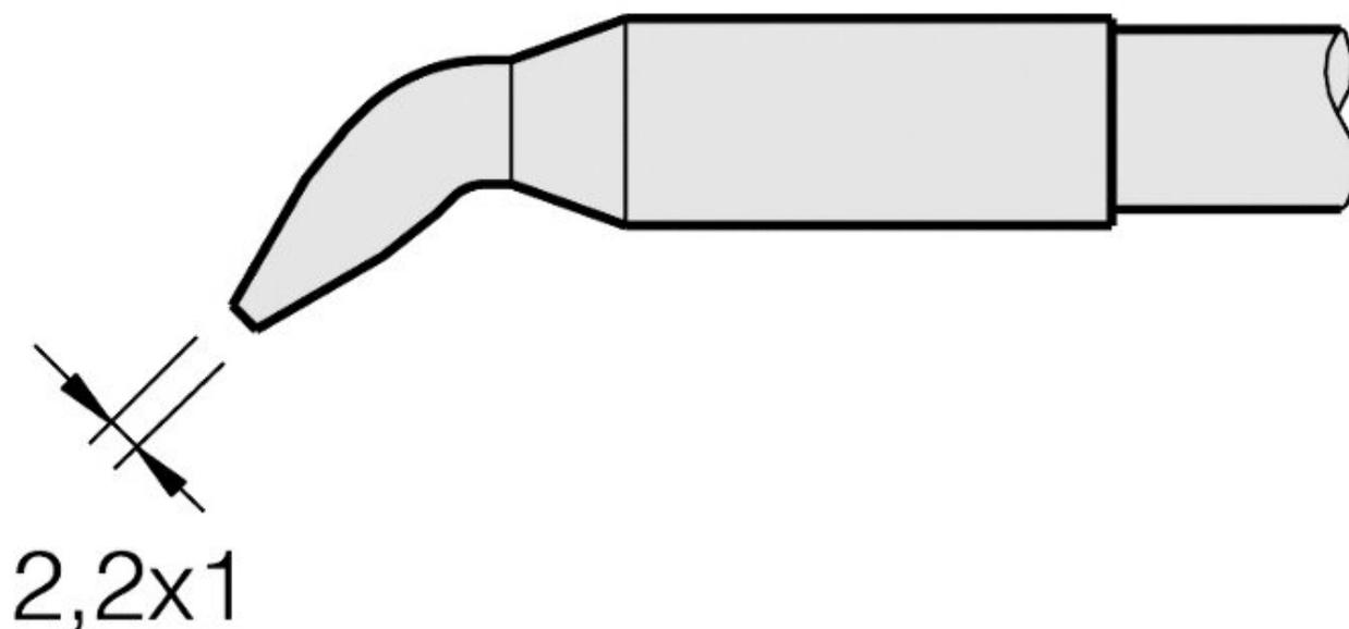
Le serie di punte per saldatura C130 sono adatte al manipolo AP130 e hanno punte curve che si adattano perfettamente alla posizione del filo di stagno. Le punte possono essere allineate sul manipolo tramite il dispositivo antitorzione.
