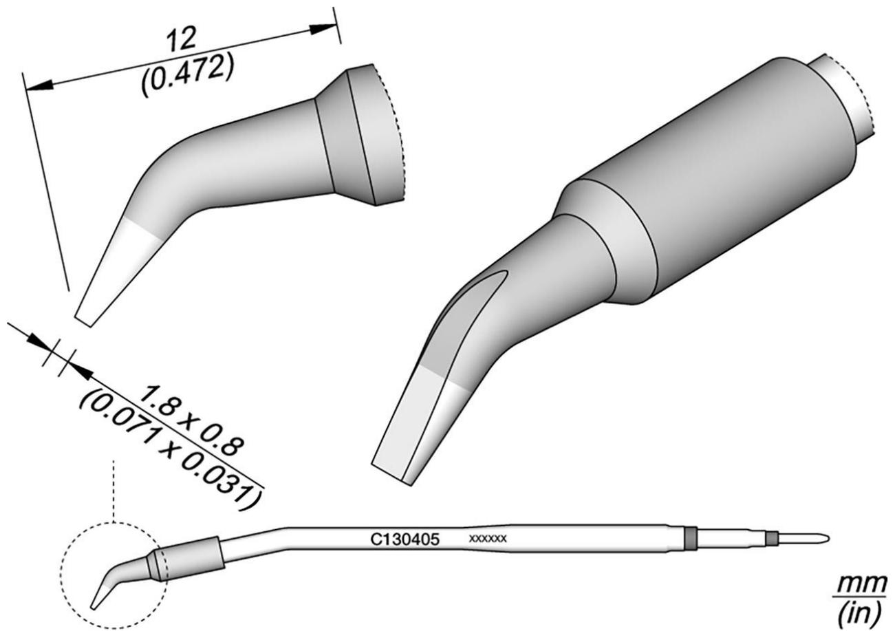
Le serie di punte per saldatura C130 sono adatte al manipolo AP130 e hanno punte curve che si adattano perfettamente alla posizione del filo di stagno. Le punte possono essere allineate sul manipolo tramite il dispositivo antitorsione.
