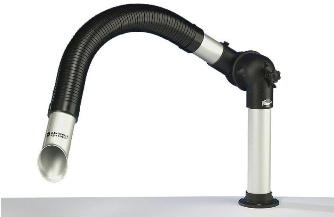
Il sistema Alsident System 50 Flex è progettato per un volume d'aria di 45 - 85 m<sup>3</sup>/h e ha un diametro del tubo di 50 mm. Il sistema Flex è particolarmente adatto all'industria elettronica e ai laboratori. Il braccio di estrazione ESD è naturalmente conforme ai requisiti della DIN EN 61340-5-1.
