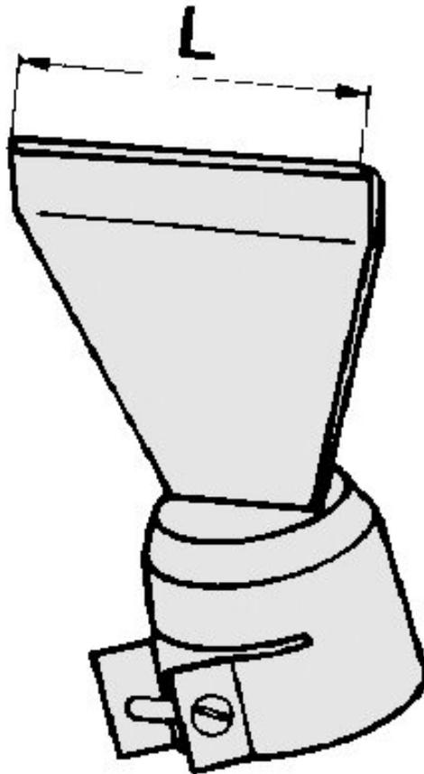
Ugello per aria calda per LABOR-S/HOTJET-S
