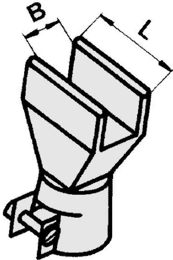
Ugello per aria calda per LABOR-S/HOTJET-S
