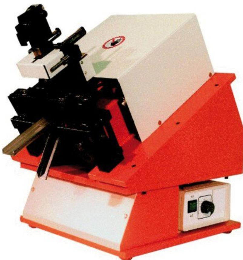
Taglio / goffratura + dispositivo di piegatura per componenti radiali
