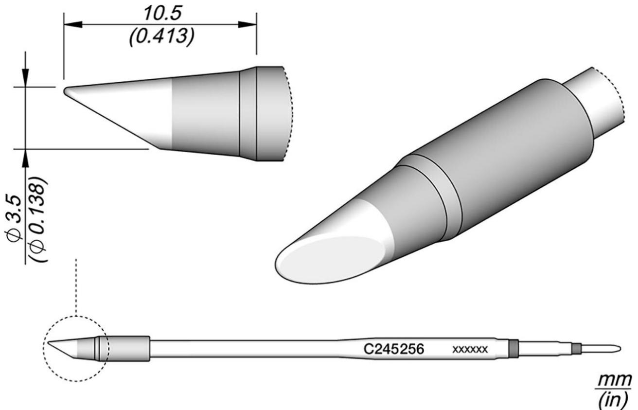
Punte di saldatura serie C245 per saldatori T245 (ex AD-2245). Sono adatti per saldature generiche. Modalità sleep e sleep nel vassoio.
