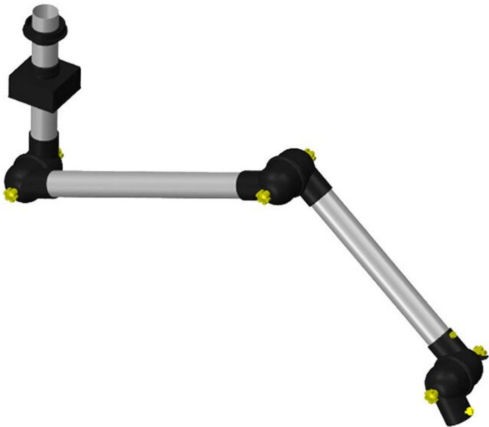
Il sistema Alsident 50 ha tubi con un diametro di 50 mm ed è adatto per volumi d'aria di 45 -85 m<sup>3</sup>/h. Di conseguenza, il sistema è ideale per l'impiego in industrie con compiti di rilevamento di piccole dimensioni, come l'industria elettronica, i laboratori, la tecnologia laser o anche le aule specialistiche nelle scuole. Il braccio di estrazione conforme alle norme ESD è naturalmente conforme alla DIN EN 61340-5-1 ed è messo a terra con una resistenza di 1MΩ.
