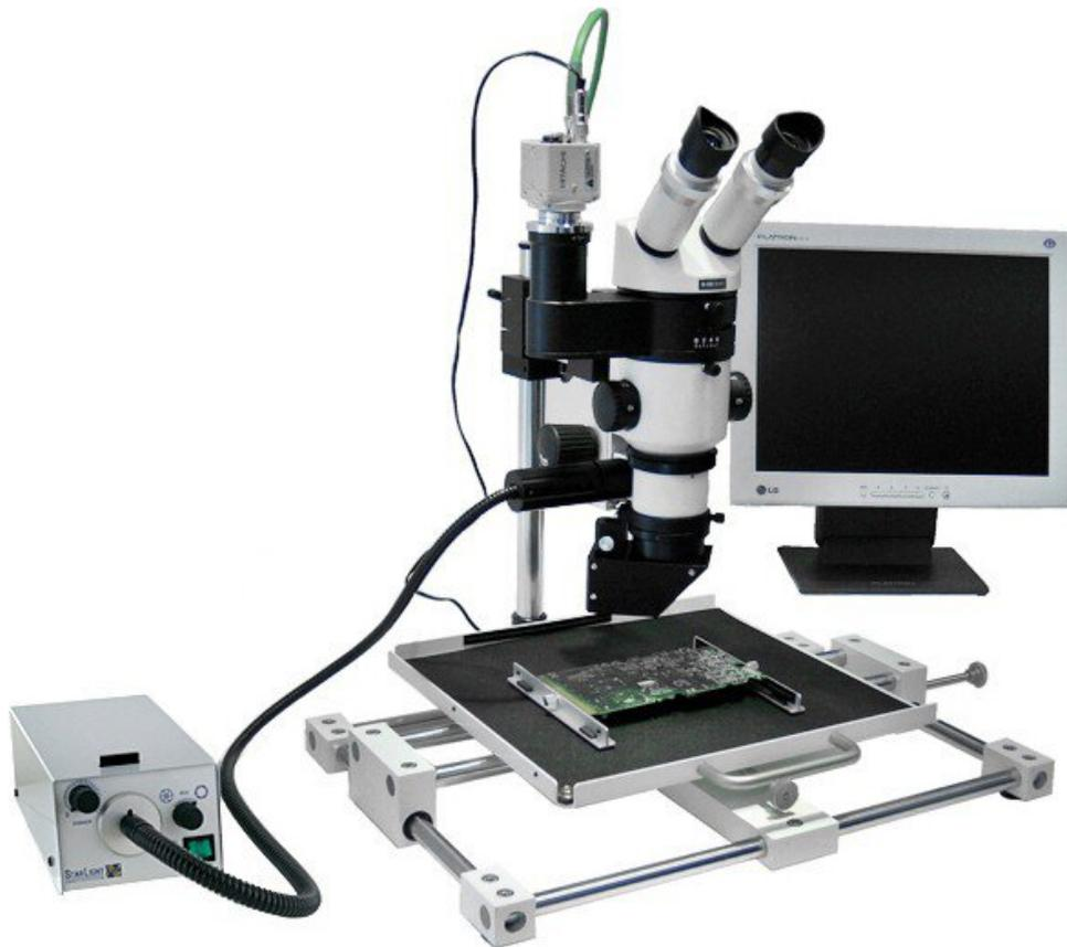
L'ispettore-400 è particolarmente adatto per l'ispezione stereoscopica di grandi parti piane. La tabella di ispezione posizionata in modo sensibile crea le condizioni ideali per un'ispezione efficace e riproducibile a qualsiasi livello di ingrandimento.
