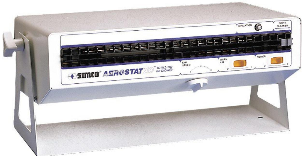
L'unità di ionizzazione Simco Aerostat-XC ESD può neutralizzare le cariche elettrostatiche nelle postazioni di lavoro ESD. Il soffiatore dell'Aerostat-XC è costituito da tre ventilatori con regolazione continua della velocità ed elemento riscaldante commutabile, che possono essere riscaldati di 6°-8°C con una temperatura ambiente di 6°-8°C. La ionizzazione si basa sull'alta tensione (tecnologia a tensione alternata CA). Manutenzione molto bassa.
