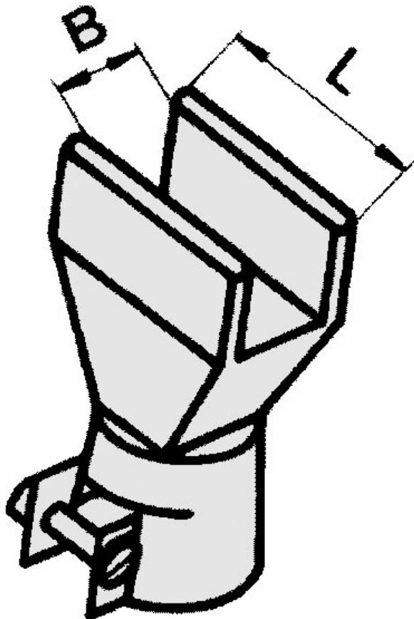
Ugello per aria calda per LABOR-S/HOTJET-S
