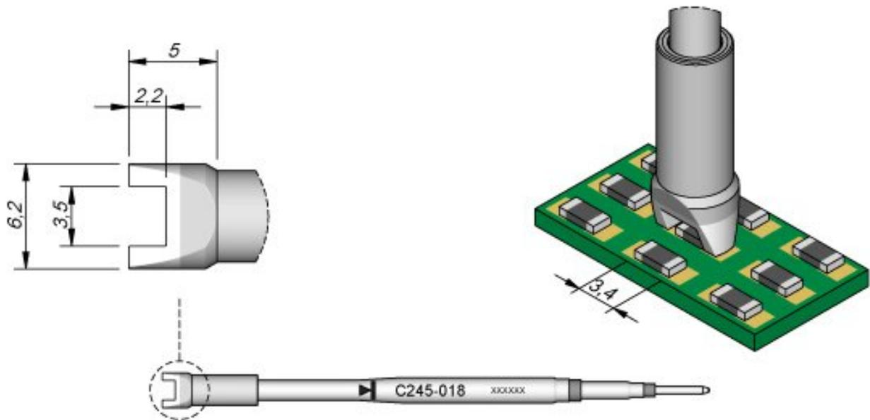
Punta dissaldante SMD della serie C245 per saldatore T245 (ex AD-2245)
