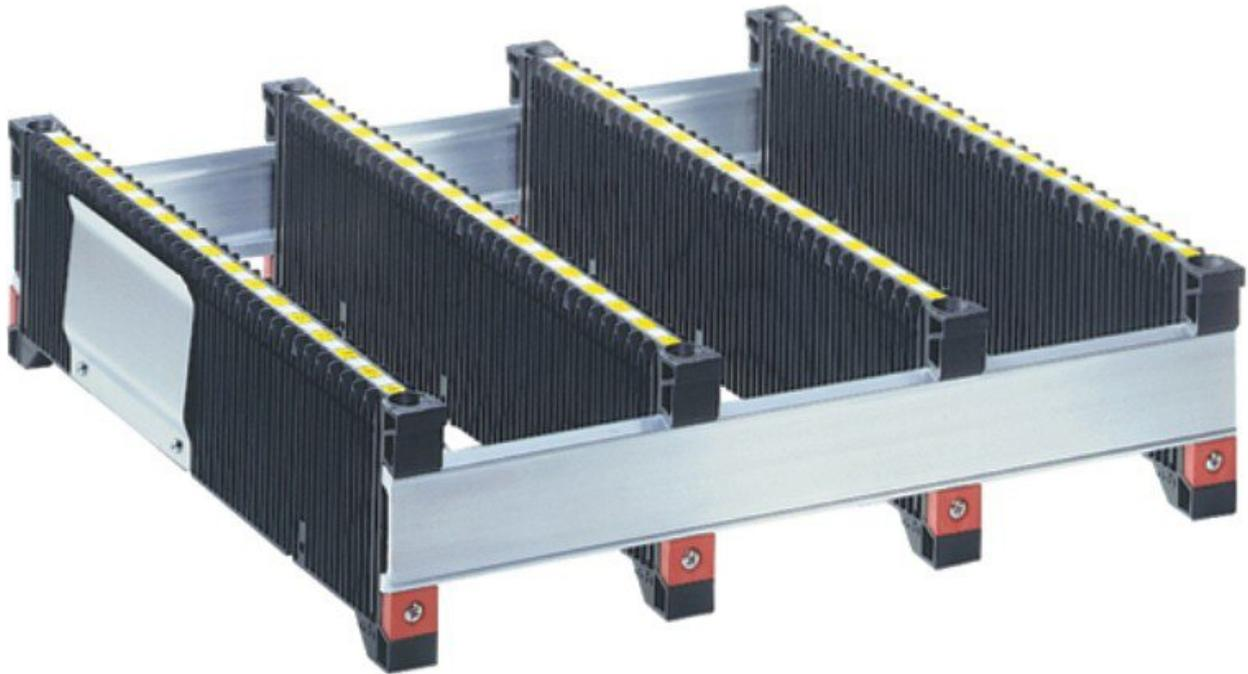
I supporti per PCB possono essere caricati sia in posizione verticale che orizzontale. Il sistema è assolutamente variabile in larghezza e può essere montato per adattarsi a tutte le dimensioni dei PCB. Per i vari PCB sono disponibili supporti per PCB alti 100, 180 e 300 mm. Con 32 scanalature di guida a intervalli di 10 mm, i supporti per PCB offrono la massima densità di imballaggio.
