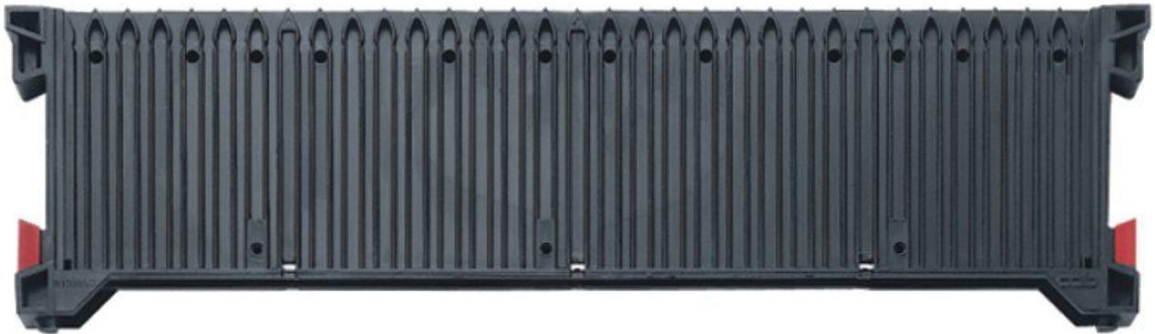
I supporti per PCB possono essere caricati sia in posizione verticale che orizzontale. Il sistema è assolutamente variabile in larghezza e può essere montato per tutte le dimensioni di PCB come richiesto. Per i vari PCB sono disponibili supporti per PCB alti 100, 180 e 300 mm. Con 32 scanalature di guida a intervalli di 10 mm, i supporti per PCB offrono la massima densità di imballaggio.
