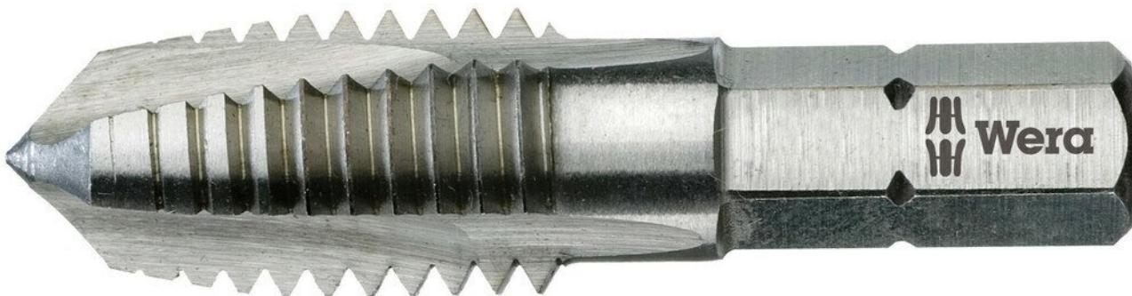
Embout de taraudage à incision de haute qualité de Wera. Pour le taraudage de filetages métriques. La tige hexagonale garantit une très bonne transmission de la force. L'élasticité finement ajustée du matériau assure une durée de vie élevée. Evacuation impeccable des copeaux et faible risque d'accrochage. Hexagone 1/4", convient aux porte-embouts selon DIN ISO 1173-D 6,3.
