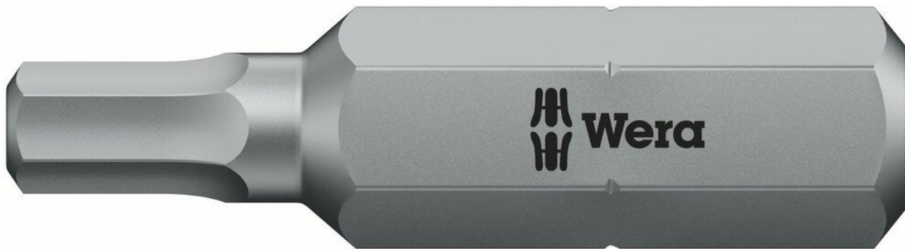
Embouts Wera durs et résistants pour vis à six pans creux, pour une utilisation universelle. Hex-Plus offre de plus grandes surfaces d'appui dans la tête de vis. L'effet d'entaille est ainsi réduit au minimum, la destruction de la tête de vis quasiment éliminée. Hexagone 5/16", convient aux porte-embouts selon DIN ISO 1173-D 8.
