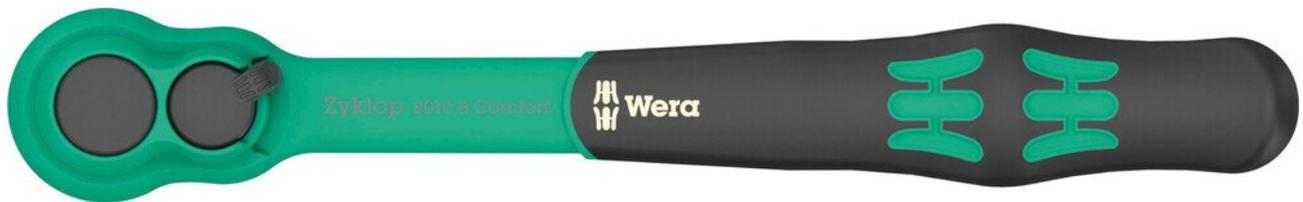
Cliquet Zyklop Comfort avec levier de commutation au design Wera irrésistible. Revêtement plastique confortable à deux composants. Protège les surfaces sensibles. Forme mince pour travailler même dans des espaces de montage très étroits. La denture fine de 80 dents permet un faible angle de reprise de seulement 4,5°. Avec levier d'inversion pour un changement aisé du sens de rotation. Avec fonction de verrouillage sûre des noix par bouton-poussoir.
