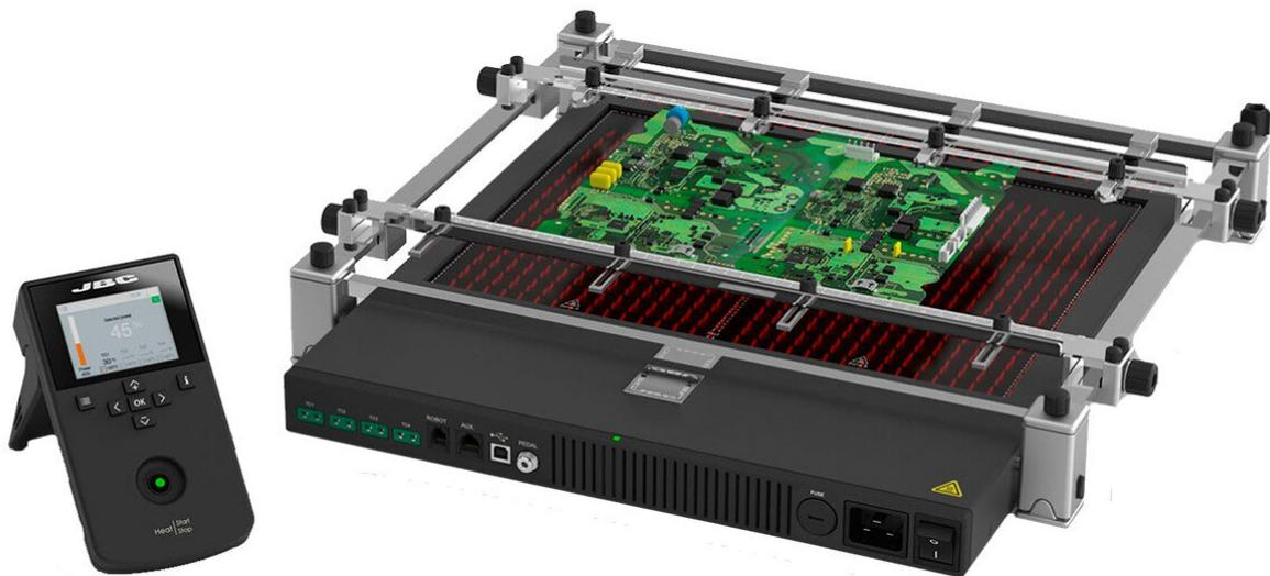
Indispensable pour éviter les chocs thermiques sur les circuits imprimés multicouches pendant les travaux de finition.
