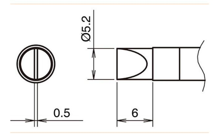
$\bullet$  pour fers à souder HAKKO FX 9701 et fers à souder HAKKO N2 FX 9702 (buse C - B 5292)
