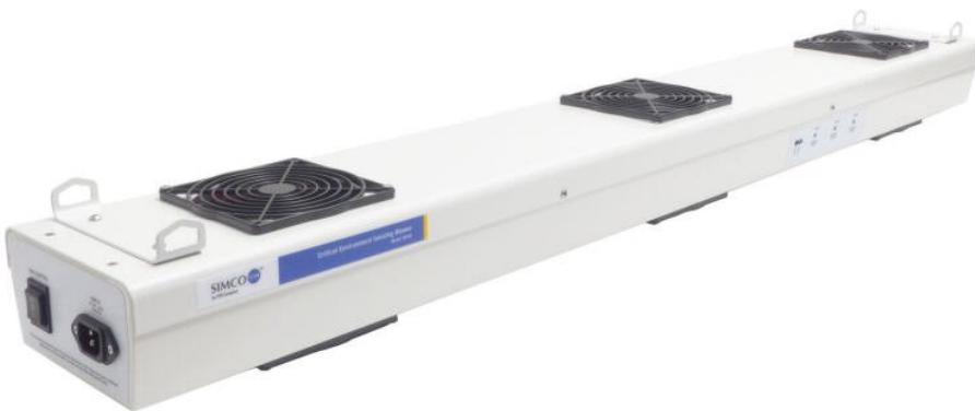
L'ioniseur 5810i est un modèle de tête à trois ventilateurs. Il est utilisé pour neutraliser les charges électrostatiques sur les lieux de travail. Le ventilateur est équipé d'un système de nettoyage automatique de l'émetteur et d'un flux d'air réglable à deux niveaux.
