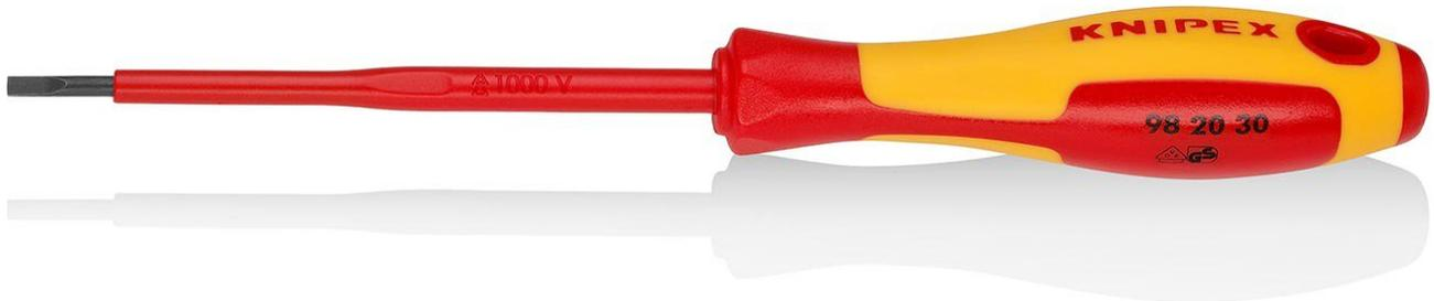
Tournevis pour vis à fente : Poignée ergonomique optimisée à 2 composants pour une transmission de force sans fatigue et sans danger pour la main. Forme de la poignée empêchant le roulement. - Longueur de la lame : 100mm - longueur de la lame non isolée : 15mm - longueur du manche : 102mm - largeur du tranchant : 3,0mm - épaisseur du tranchant : 0,5mm - testé VDE : Oui
