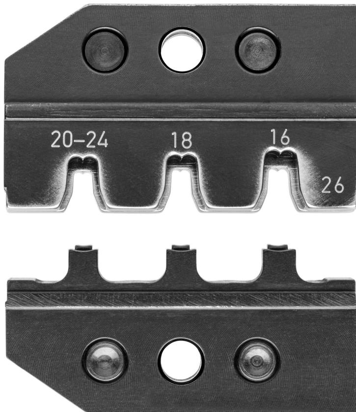
Jusqu'à 250 profils disponibles ; profils spéciaux sur demande. - Application : Pour le sertissage des connecteurs de la série Mini-Fit® de Molex LLC - Nombre de cavités : 3 - AWG : 24 - 20 / 18 / 16
