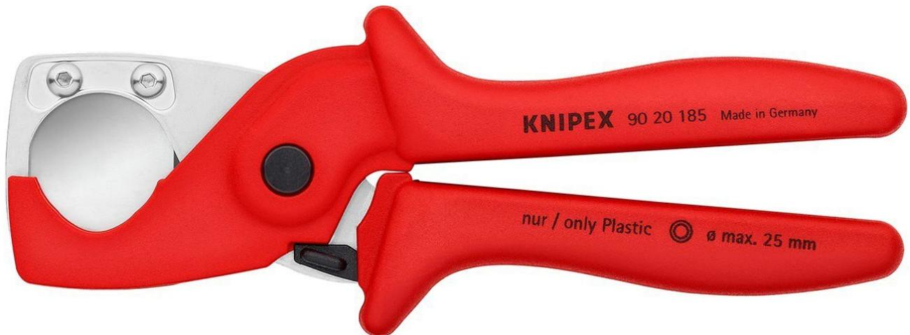
KNIPEX PlastiCut<sup>®</sup> : Pour couper les tubes en plastique à paroi mince (par ex. tubes blindés en plastique) et les tuyaux, également renforcés de tissu, en plastique et caoutchouc jusqu'à Ø 25 mm de diamètre extérieur. Ne convient pas pour la coupe de câbles. Avec ressort d'ouverture et cliquet d'arrêt. - Capacités de coupe (diamètres) : Ø 25mm - Longueur de coupe mm : Ø 25mm
