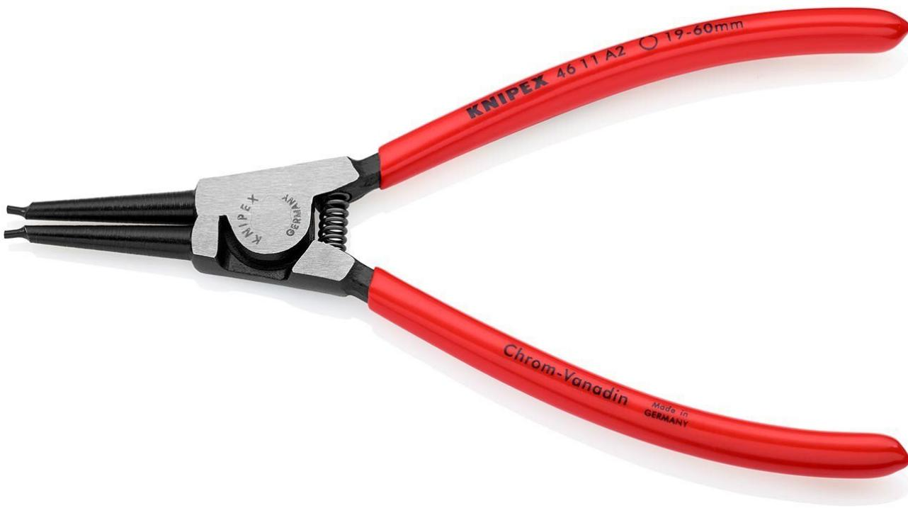
Forme robuste, forgée. Pointes antidérapantes et solides. Pointes droites. DIN 5254 A ; pointes droites. - Forme : 1 - Capacité pour diamètre d'arbre : Ø 19 - 60mm - Pointes (diamètre) : Ø 1,8mm
